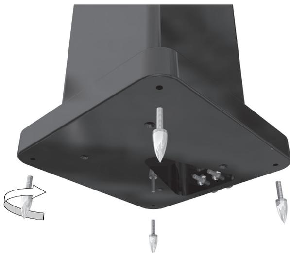
Шипы вкручиваются в освободившиеся отверстия по часовой стрелке. Убедитесь, что шипы вкручены полностью, поднимите колонку и установите её на предназначенное для неё место. Убедитесь, что колонка стоит ровно (если нет, отрегулируйте соответствующим образом шипы, а затем затяните стопорную гайку, чтобы зафиксировать шипы в нужном положении).
