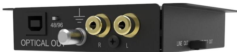
Правильно подключайте левый и правый каналы. Правый канал обычно имеет красную маркировку, а левый – черную или белую. Провод заземления тонарма необходимо подключить к клемме заземления на вашем усилителе (если есть).
