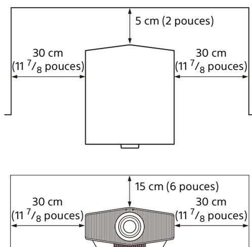
Remarquez que le mur situé du côté des orifices de ventilation peut devenir brûlant. Les flux d'air des climatiseurs ou des orifices de ventilation de cet appareil, ou d'autres, peuvent faire osciller l'écran. Veillez à ne pas installer cet appareil dans un endroit où sa face avant risque d'être soumise aux flux d'air des climatiseurs ou des orifices de ventilation de ces autres appareils.
