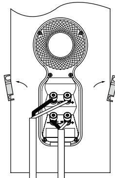
Bizonyosodjon meg arról, hogy a hangsugárzó pozitív terminálja (+ jellet jelölt és piros színű) az erősítő pozitív kimenetéhez csatlakozik, valamint a hangsugárzó negatív terminálja (- jellet jelölt és fekete színű) az erősítő negatív pontjához csatlakozik. Fordított csatlakozás esetén a hangkép zavaros és a mélyhang hiányos lesz. A zörgések elkerülésének érdekében minden szorosan húzza meg a csatlakozókat.
