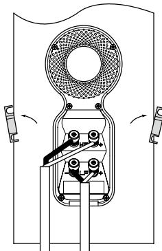
Upewnij się, że gniazda połączeniowe z czerwonym obramowaniem zostały połączone z gniazdami o dodatniej polaryzacji na wzmacniaczu a gniazda z czarnym obramowaniem z gniazdami o ujemnej polaryzacji na wzmacniaczu.
