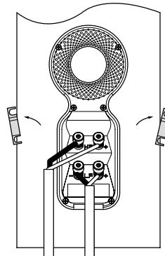
Voordat u apparatuur aansluit of iets aan de verbindingen verandert, altijd eerst alle apparatuur uitschakelen.
