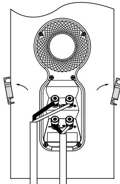
Подсоедините плюсовый разъем колонки (со знаком + и окрашенный в красный) к плюсовому выходу усилителя, а минусовой (со знаком – и окрашенный в черный) – к минусовому на усилителе. Неверное подключение приведет к искажению звукового образа и утере басов.
