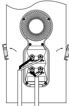
Asegúrese de que los terminales positivos de la caja acústica (marcados como + y de color rojo) son conectados al terminal de salida positivo del amplificador y que los terminales negativos de la caja acústica (marcados como - y de color negro) son conectados al terminal de salida negativo del amplificador. Una conexión incorrecta podría tener como resultado una imagen sonora pobre y una pérdida de graves.
