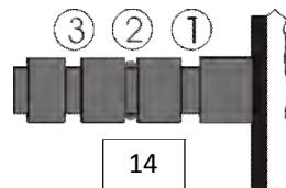
Закрепите петлю нити грузика компенсации противоскатывающей силы в канавке наконечника регулировки противоскатывающей силы (14), соответствующей прижимной силе, прилагаемой к вашему звукоснимателю, и проденьте нить через петлю опоры проволоки (16).
