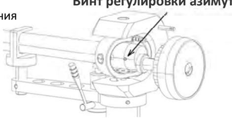
С помощью соответствующего увеличительного стекла отрегулируйте иглу, пока она не будет находиться в вертикальном положении в канавке (т.е. перпендикулярно поверхности грампластинки). В идеале эта регулировка должна соответствовать положению, в котором верхняя поверхность корпуса звукоснимателя параллельна поверхности грампластинки.
